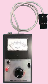
メーターリレー試験器
